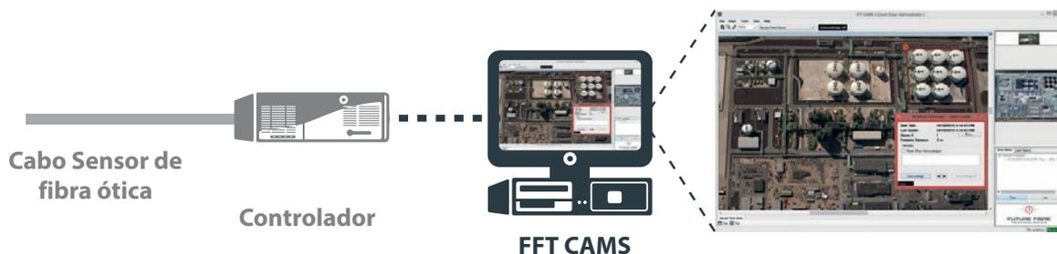
Conectar os controladores FFT ao FFT CAMS™ permite que a localização de um alarme de intrusão seja mostrada em uma interface de usuário baseado em mapas; seja através do FFT CAMS ou por meio de um sistema terceiro de gestão de segurança.
