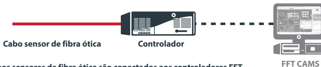
Os cabos sensores de fibra ótica são conectados aos controladores FFT.
