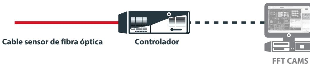
**El cable sensor de fibra óptica está conectados a los controladores de FFT.**
